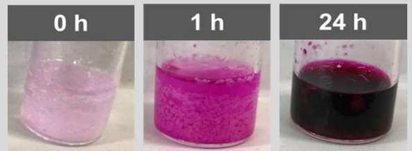
アンモニア水で分解するポリエステル。着色は分解により遊離するフェノールフタレイン由来
