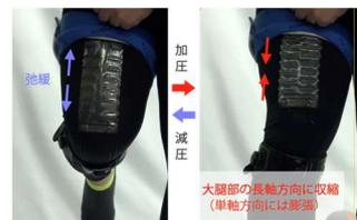
低空気圧駆動によって収縮力(アシスト力)を生み出すポリウレタン製のインフレーターアクチュエータ。大腿部の前面後面に着用することで膝関節の運動をアシスト
